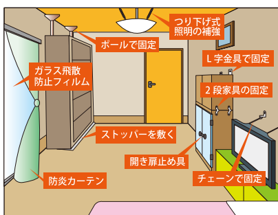
転倒防止器具の取り付け例
