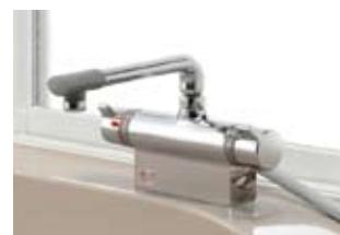
簡単に言うと温度調節のできる水栓です。ハンドルが2つ付いていて片方で水量を、もう片方で温度を調節します。サーモスタッフ水栓ならすばやく自動で温度調節してくれるので捨て水の量を最小限にすることができます。これがサーモスタッフ水栓が節水にいいと言われる一番の理由です。もちろん節水だけでなく、ハンドルを回すだけで温度を調節するので、手間を省ける点も大きなメリットです。
